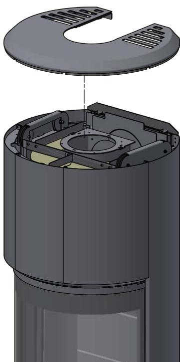
Retirer 2 vis de chaque côté à l'aide d'une clé de 10 mm
