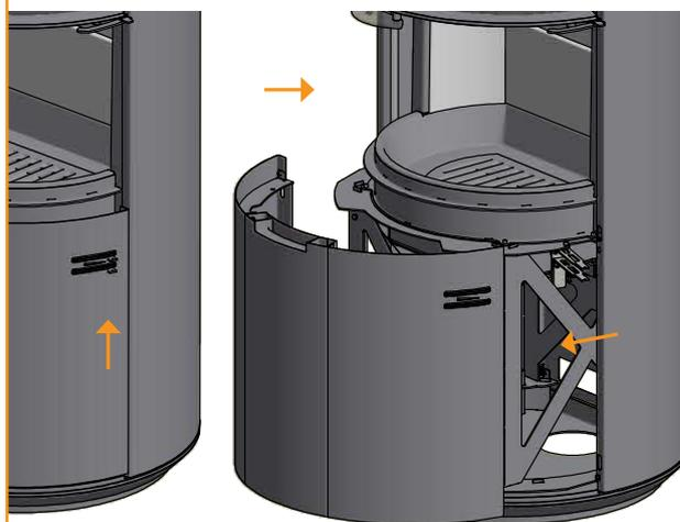
Démonter les vis de la plaque de couverture du socle
