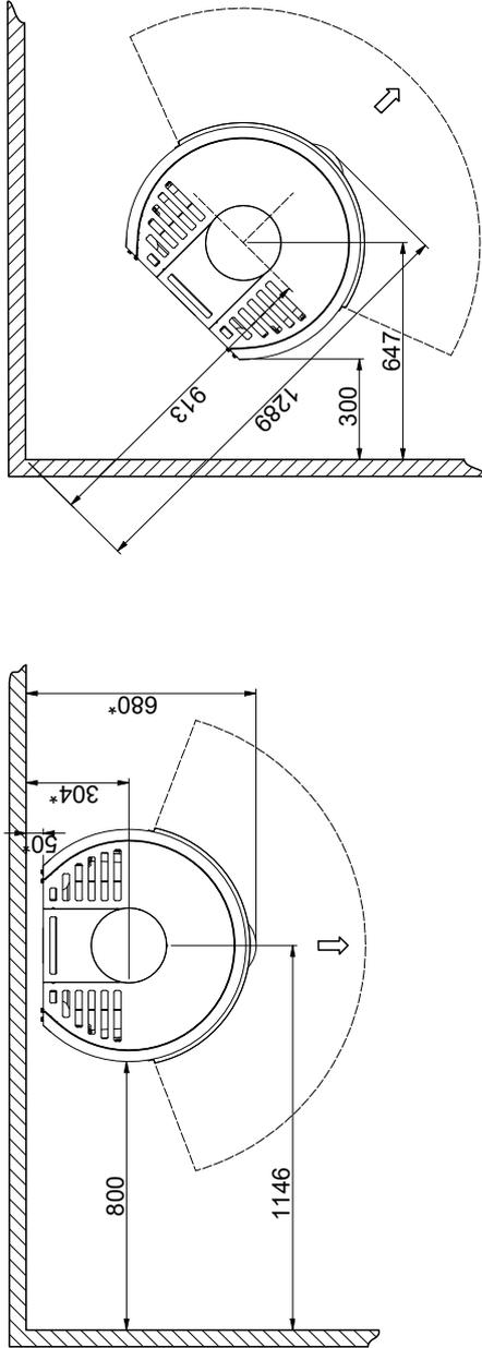
Distance minimale à un mur inflammable avec une protection thermique
