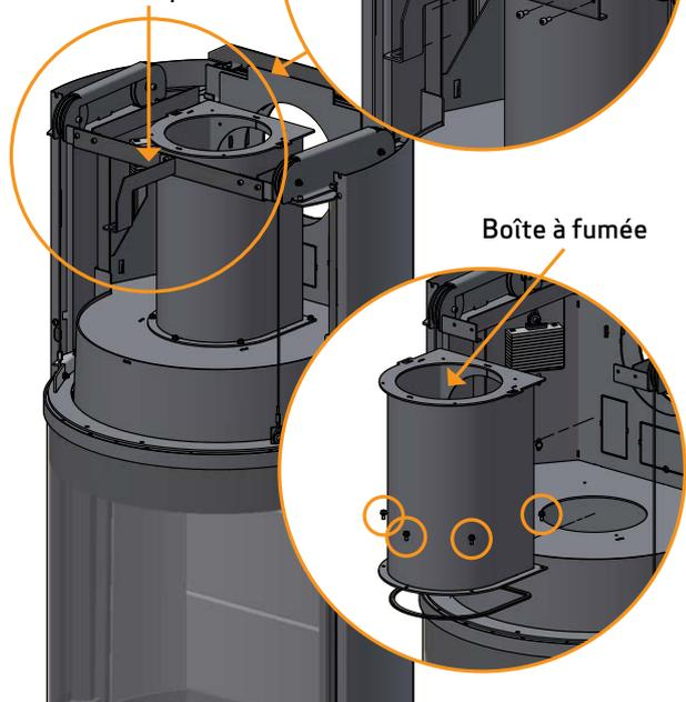
Installer la pièce de raccordement à l'aide des 4 vis qui se trouvent dans la chambre de combustion du poêle
