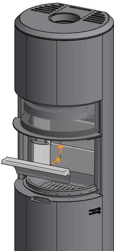
Installer le déflecteur de fumée inférieur. Le déflecteur de fumée inférieur doit prendre appui sur le doublage arrière
