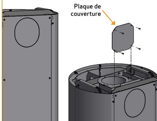
Pour faciliter le raccordement de l'appareil, il est possible de retirer la boîte à fumée en démontant le parement de façade et l'arrêt de porte. Cette solution est notamment conseillée pour les installations murales
