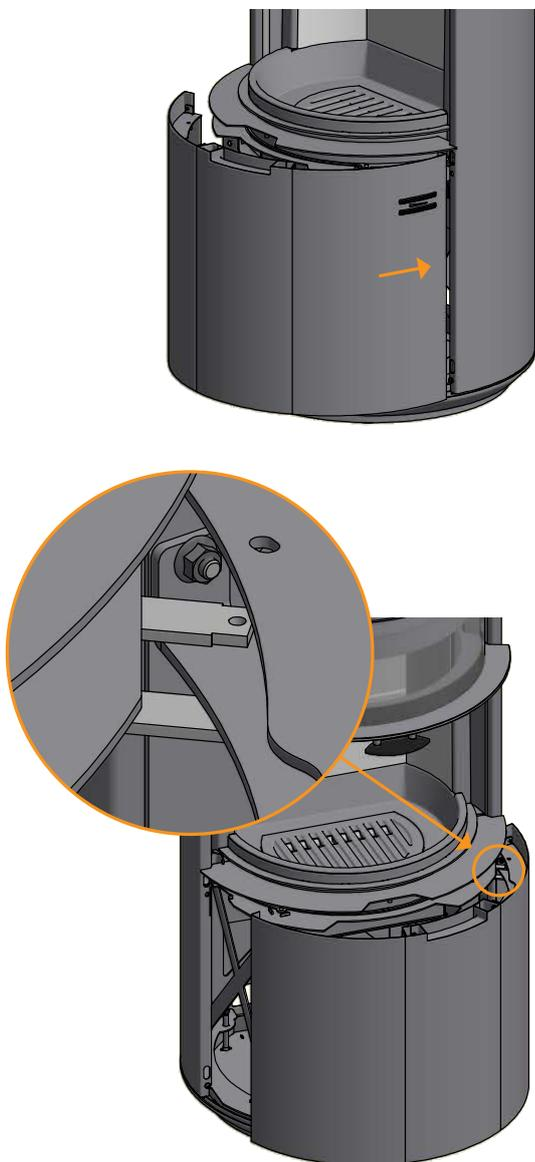
Soulever l'avant du socle et le rabaisser en position. Les boutons de réglage de combustion peuvent alors être remontés
