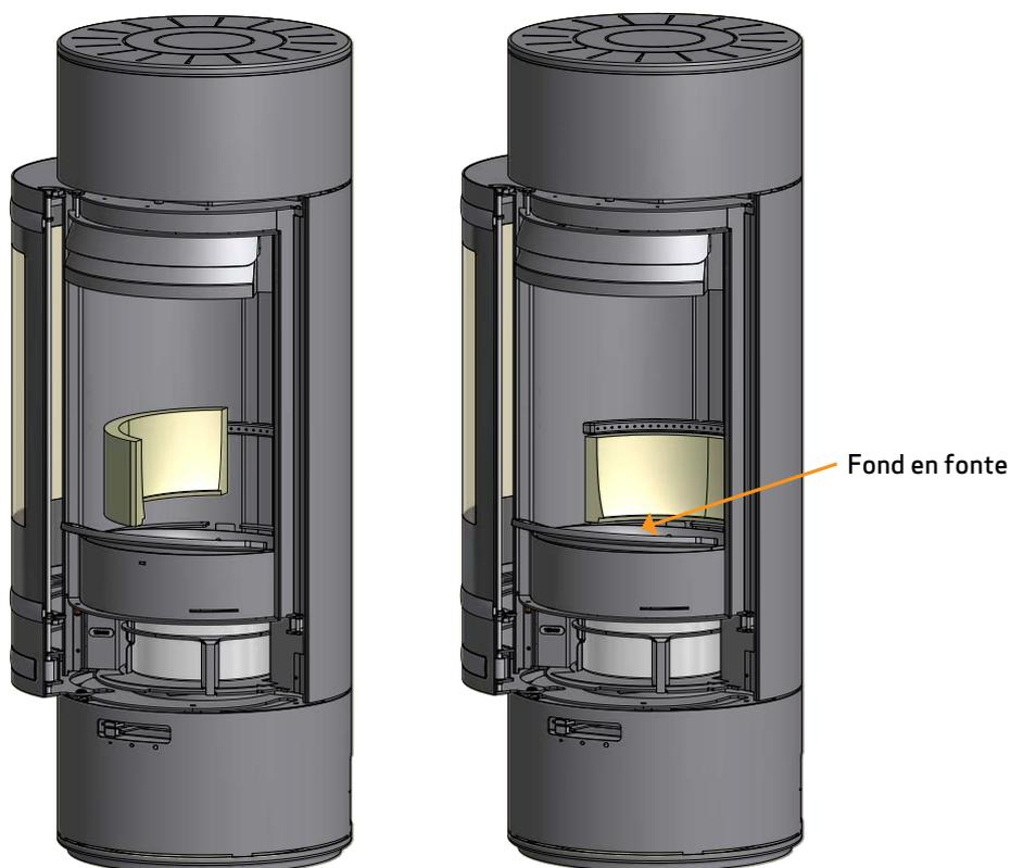
Installer les parois latérales et les plaques arrière de la doublure du foyer
