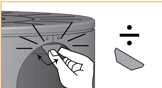
2 Soulever et retirer le module supérieur et la pièce de raccordement du poêle afin de pouvoir retirer la plaque de couverture de l'écran de chaleur
