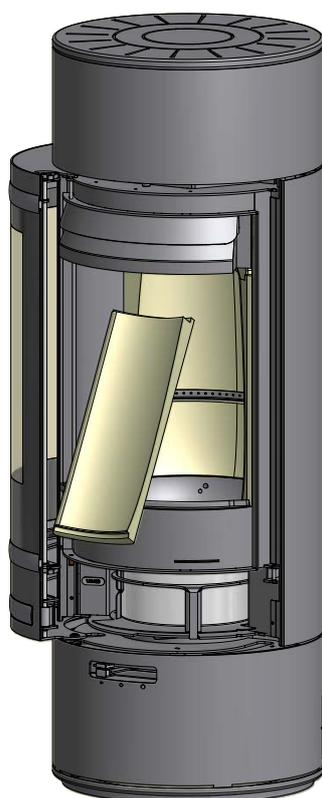
Installer le déflecteur de fumée inférieur. Le déflecteur de fumée inférieur doit prendre appui sur le doublage arrière
