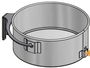
Ouverture de positionnement de la garniture de guidage du cendrier
