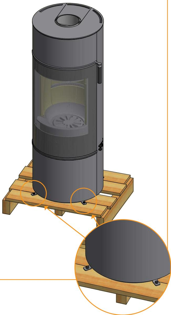
Démonter la vis et la garniture de fixation du poêle sur la palette en bois
