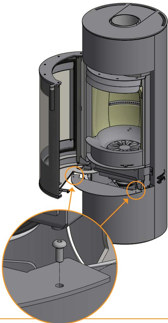
Réglage des vis d'ajustage
