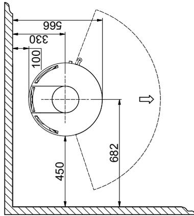
Distance minimale à un mur inflammable avec une protection thermique
