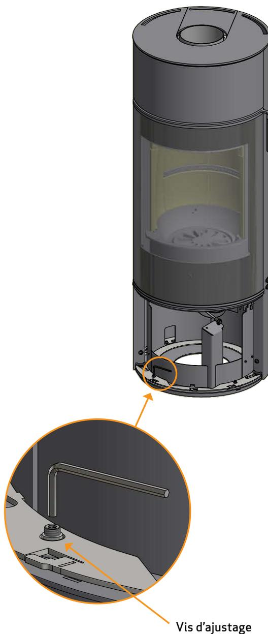
Desserrez légèrement les vis et relever l'avant du socle pour le retirer
