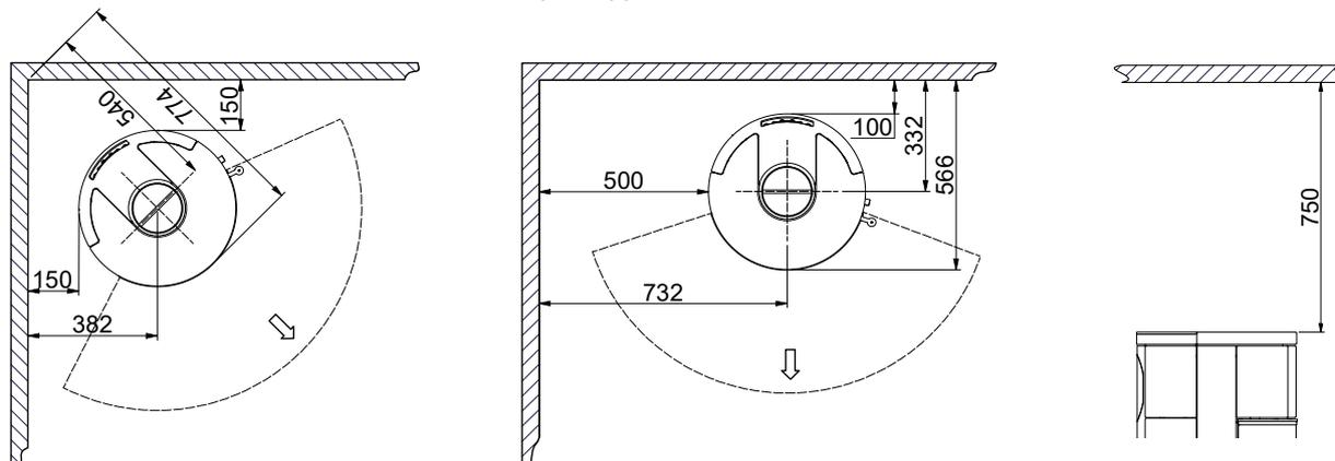
Distance minimale par rapport aux matériaux inflammables avec socle tournant (Accessoire)
