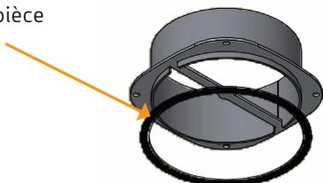
Installer la pièce de raccordement à l'aide des 4 vis
