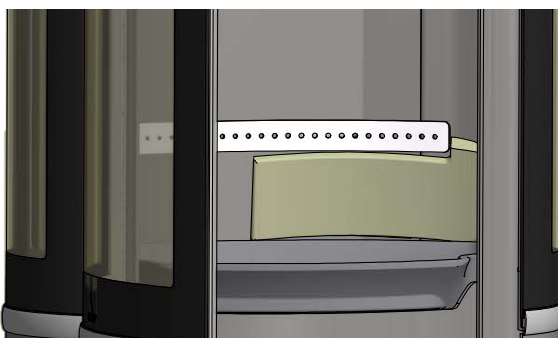
Monter les plaques de vermiculite 2a et 2b
