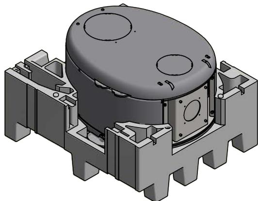
Démonter la plaque arrière en retirant les 4 vis - poser la plaque arrière sur un sol régulier ou un support similaire
