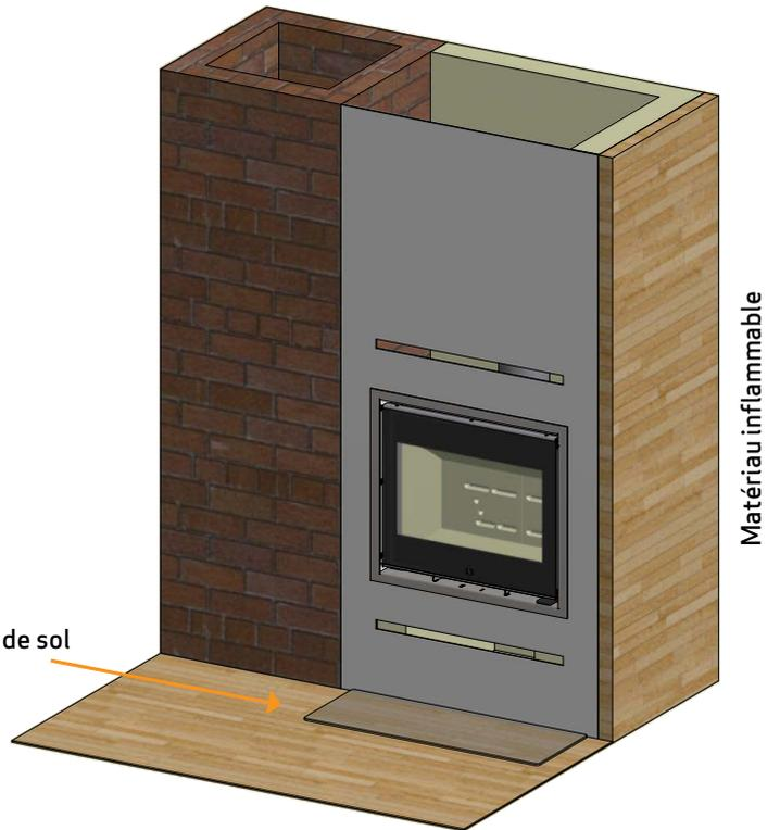
En cas d'encastrement dans un matériau inflammable protégé par une isolation, ces plaques de couverture doivent être démontées
