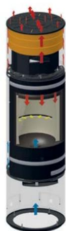
Le kit d'accumulation de chaleur, très compact, se trouve dans la rehausse supérieure du poêle et emmagasine l'énergie calorifique produite par la combustion.
